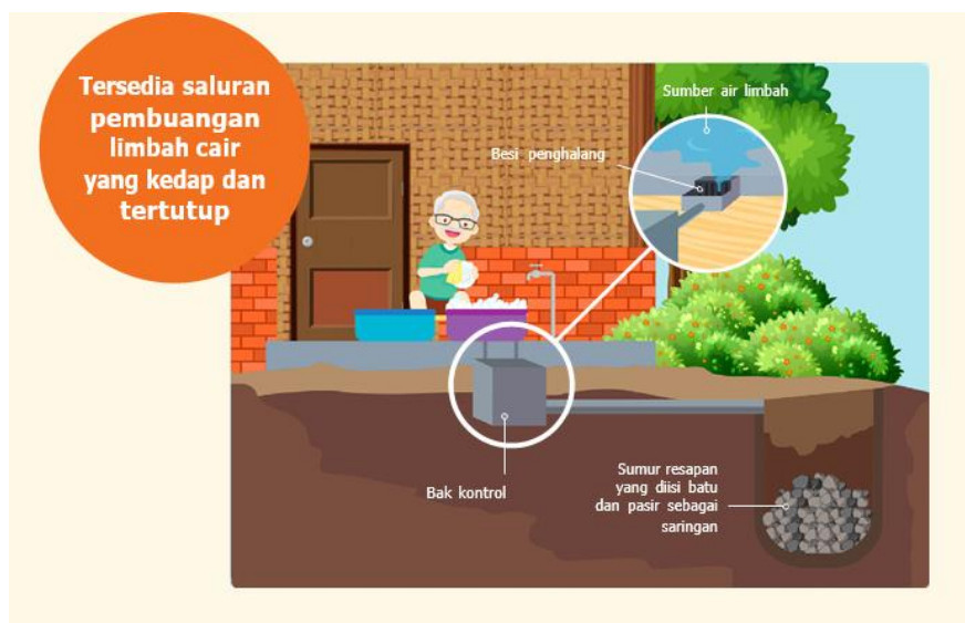
Gambar: Skema Pengolahan Air Limbah Domestik
